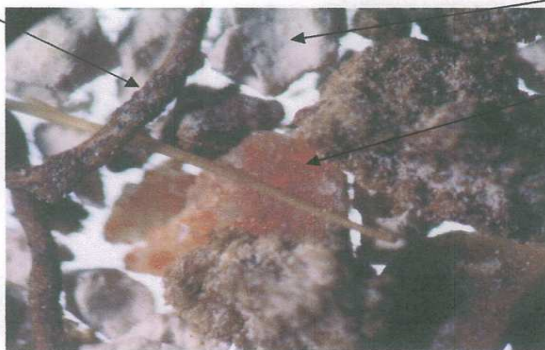
ベース材（透水・保水材）実態顕微鏡検鏡象
